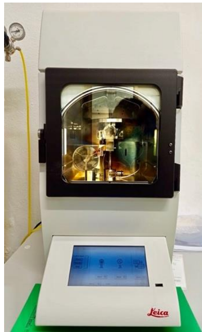
Figure. 1. The Leica EM ACE600 sputter-coater at the CISUP ESEM-FEG lab.
